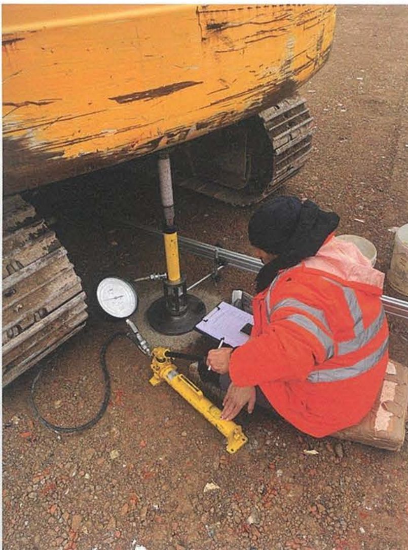
Fase di costruzione del rilevato in aggregato riciclato e prove di carico su piastra Construction phase of the recycled aggregate embankment and plate load tests
